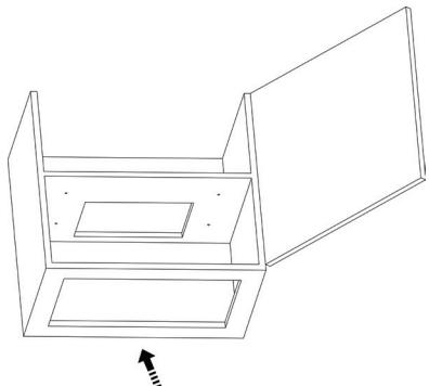
Установите переходник и антивозвратный клапан на выпускное отверстие вытяжки.
