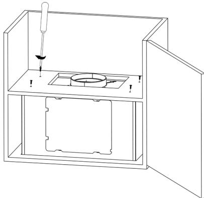
Установите вытяжку в кухонный шкаф. Закрепите вытяжку с помощью **4 винтов M5x26**.
