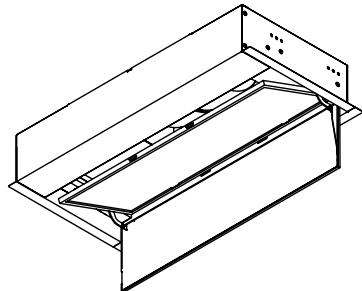
Угольные фильтры можно использовать для улавливания неприятных запахов. Обычно угольные фильтры следует менять каждые **3-6 месяцев** в соответствии с вашими кулинарными привычками. Процедура установки угольного фильтра приведена ниже:
